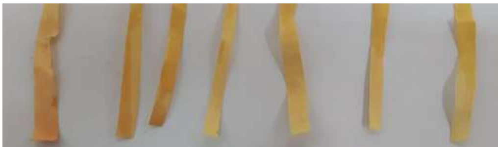
Gambar 4 Hasil deteksi standar sianida secara konvensional menggunakan metode kertas pikrat setelah 28 jam (konsentrasi CN- kiri-kanan: 4; 2; 1; 0.5; 0.25; 0.125; dan 0.0625 ppm)
